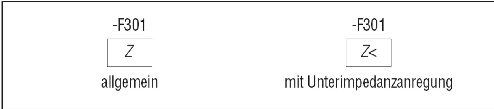
Bild 7-7 Distanzschutz-Schaltzeichen
