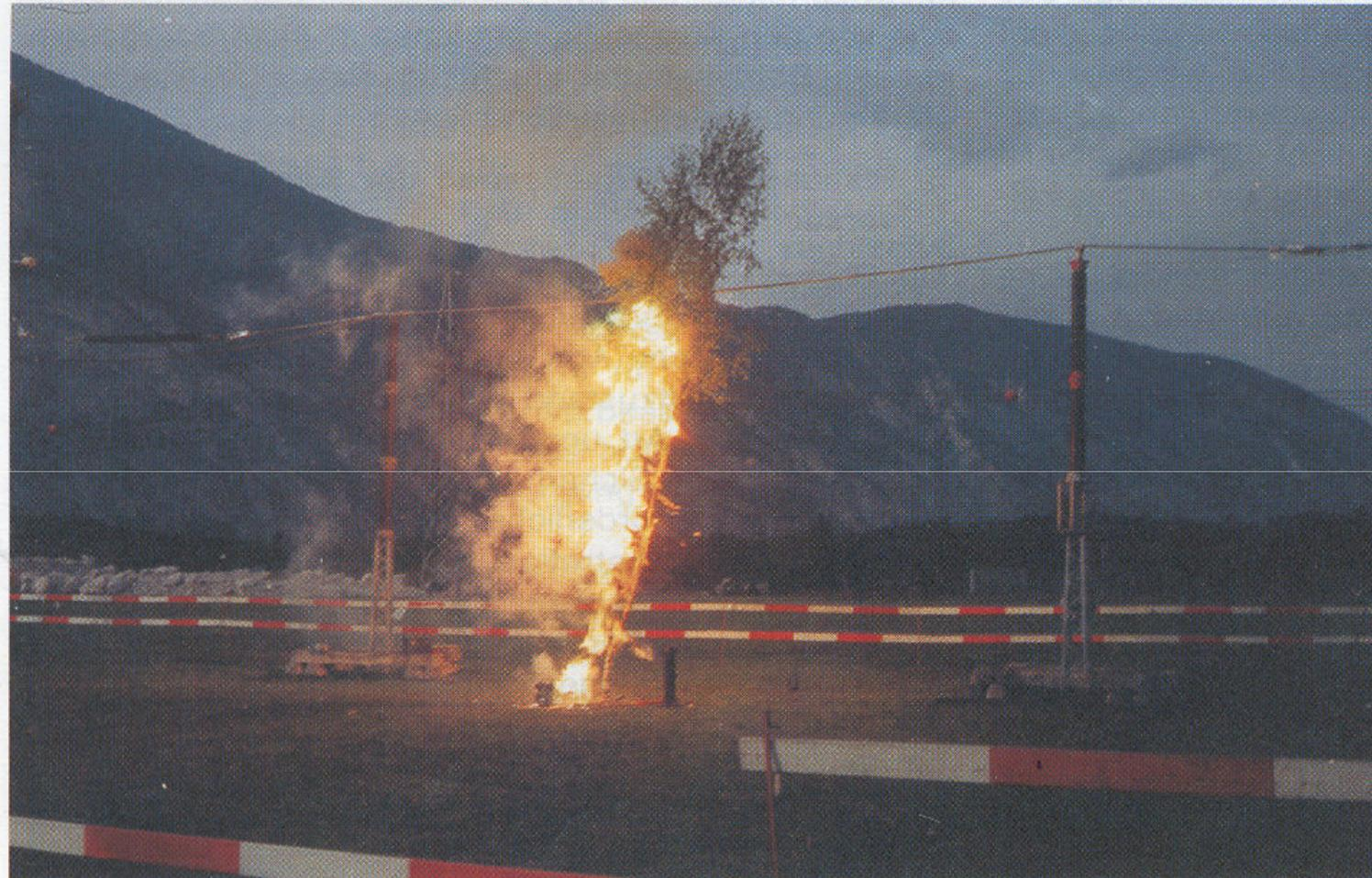
Abb. 1. 380-kV-Lichtbogen-Kurzschluß über einen grünen Baum, Kurzschlußdauer 80 ms
